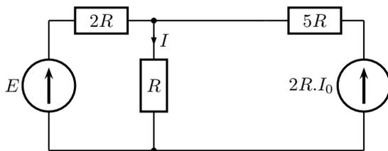
Puis ensuite on passe aux générateurs de Norton, car deux générateurs de courant en parallèle sont équivalents à un générateur de courant qui débite la somme des courants de deux générateurs : on a d'abord effectué la transformation en générateurs de courant.
