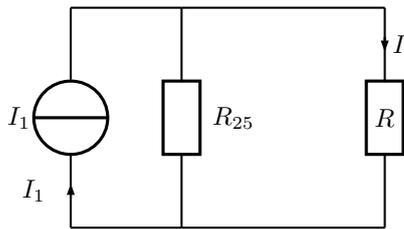
Le générateur équivalent débite donc  $I_1 = \frac{E}{2R} + \frac{2}{5}I_0$ . La résistance équivalente aux deux résistances  $2R$  et  $5R$  en parallèle est donc  $R_{25} = \frac{2R \times 5R}{2R + 5R} = \frac{10}{7}R$ .
