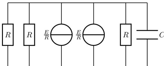
Les deux résistances  $R$  en parallèle peuvent être remplacées par une résistance  $\frac{R}{2}$  et le générateur équivalent débitera la somme  $\frac{2e}{R}$ .
