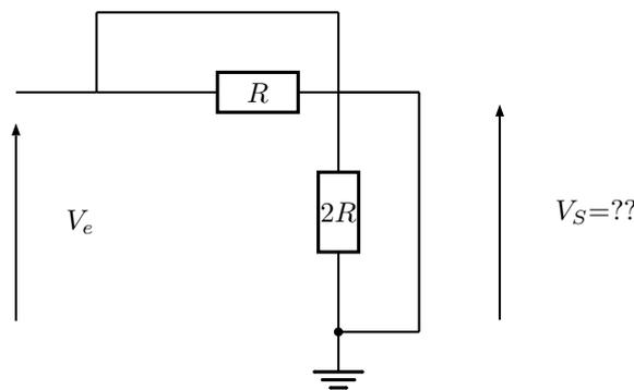
On voit à droite que la tension  $V_S$  aux borne d'un fil doit être nulle, alors qu'à gauche le fil impose que  $V_e = V_S$ , ce qui nous donne une indétermination car  $V_e \neq 0$ .
