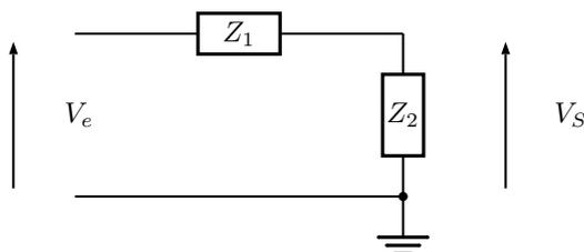
L'impédance  $Z_1$  est constituée de  $C//R$  donc  $Z_1 = \frac{Z_C R}{Z_C + R} = -\frac{jR}{\omega C R - j}$  par exemple après simplification, en se rappelant que  $Z_C = \frac{1}{jC\omega}$ . Néanmoins, je rappelle qu'il est souvent plus simple de penser à utiliser  $Y_C = \frac{1}{Z_C}$  dans les calculs pour les simplifier car  $Y_C = jC\omega$  est plus simple à manipuler. Ainsi, on chercherait
