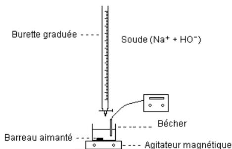
Dans le bécher, on a placé l'acide. L'agitateur magnétique permet d'homogénéiser la solution. Le pH-mètre comporte une seule (double) électrode. La burette graduée est remplie de solution de soude.
