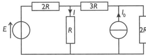
Calculez l'expression du courant  $I$  en fonction des données du schéma ( $E$ ,  $I_0$ ,  $R$ ) en utilisant les méthodes suivantes :
