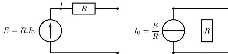
On peut donc transformer le schéma électrique progressivement :
