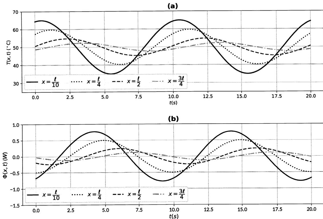
FIGURE 4 – (a) : Température dans un conducteur de platine en fonction du temps, pour différentes valeurs de  $x$ . (b) : Flux thermique dans le même conducteur en fonction du temps, pour les mêmes valeurs de  $x$ . La fréquence vaut  $f = 0,1 \text{ Hz}$ , les températures  $T_{01}$  et  $T_{02}$  valent  $T_{01} = 20^\circ \text{C}$  et  $T_{02} = 50^\circ \text{C}$ .
