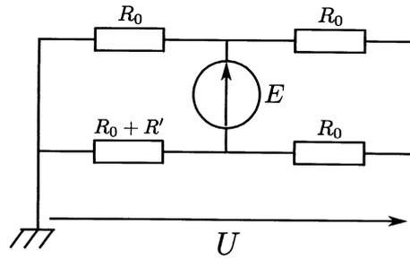
FIGURE 6 – Montage permettant de déterminer la valeur de  $R'$  en mesurant la tension  $U$ . La valeur de la tension  $E$  est fixée par l'utilisateur. On prendra  $E = 10 \text{ V}$ . Les valeurs des résistances usuelles sont prises à  $R_0$ .
