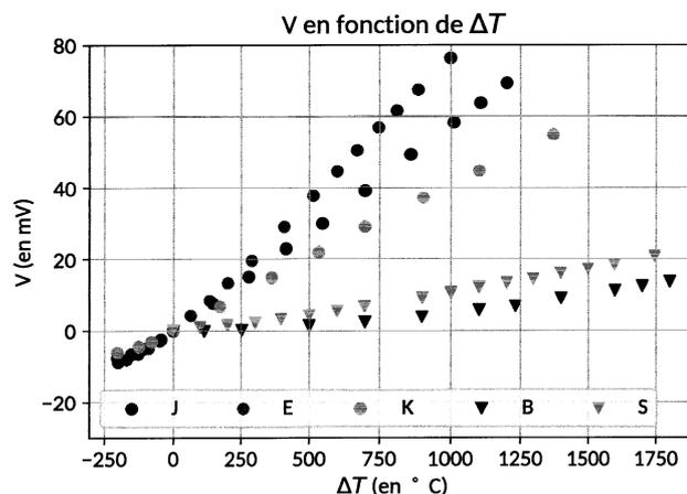
FIGURE 9 – Évolution de la différence de potentiel mesurée pour différents thermocouples, en fonction de l'écart  $\Delta T$  à la température de référence, pour une température de référence  $T_{\text{ref}} = 0^\circ\text{C}$ . Les thermocouples de type B et S contiennent du platine, et ceux de type J, E et K contiennent du nickel.
