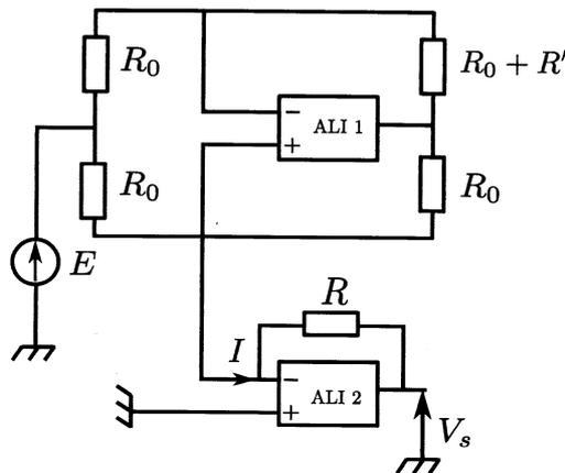
FIGURE 7 – Montage de mesure de température. Les ALI sont supposés idéaux, et fonctionnent en régime linéaire.
