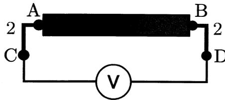
FIGURE 5 – Jonction thermoélectrique entre deux matériaux 1 et 2.
