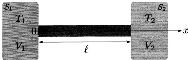
FIGURE 1 – Le dispositif complet est constitué de deux solides notés  $\mathcal{S}_1$  et  $\mathcal{S}_2$ , portés à des températures  $T_k$ , avec  $k = 1, 2$ , et des potentiels électriques  $V_k$  différents, reliés par un conducteur de longueur  $\ell$ . Le barreau reliant les deux réservoirs a une longueur  $\ell = 2 \text{ cm}$  et un rayon  $a = 1 \text{ mm}$ . L'origine des positions est prise à la jonction entre le barreau et le solide  $\mathcal{S}_1$ .
