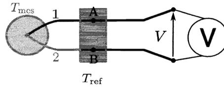
FIGURE 8 – Schéma du montage permettant la mesure de la température  $T_{\text{mes}}$ . Les traits noirs épais correspondent à un conducteur de cuivre, les traits gris aux matériaux 1 et 2 constituant la jonction thermoélectrique. La différence de potentiel est notée  $V$ .
