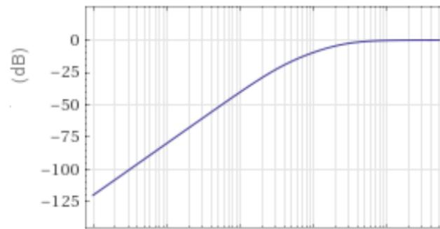
1. 5 On prend  $R = 100\Omega$ , quelle valeur de  $L$  faut-il choisir pour réaliser le filtre voulu? On considèrera que la fréquence de coupure retenue est associée à la pulsation  $\omega_0$  et vaut  $10\text{kHz}$ .
