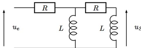
*A haute fréquence, donc pour  $\omega \rightarrow \infty$ , les bobines sont équivalentes à des interrupteurs ouverts ce qui signifie qu'aucun courant ne circule dans les résistances R, donc la tension à leurs bornes est nulle donc  $u_e = u_s$  (en prenant une grande loi des mailles), donc  $G = 1$  le gain est donc dit unitaire.*
