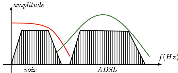
*Pour récupérer la voix, il faut un filtre passe-bas avec une fréquence de coupure entre 4 kHz et 25 kHz, et pour récupérer seulement l'ADSL ou la voix VoIP, il faut un filtre passe-haut ou un filtre passe-bande entre 25 kHz et 4 MHz, comme c'est représenté sur le schéma ci-dessus.*
