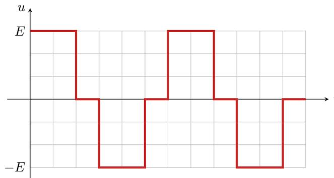
**Figure 1 – Tension de sortie de l'onduleur.**
