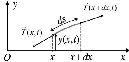
On applique le théorème du centre d'inertie au petit élément de longueur  $ds$  et de masse élémentaire  $dm = \lambda ds = \lambda \sqrt{dx^2 + dy^2} \approx \lambda dx$  :
