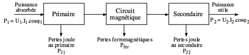
Les pertes fer sont dues à l'hystérésis du matériau ferromagnétique et aux courants de Foucault. Les pertes fer sont proportionnelles à  $B_{max}^2$  (donc à  $U_1^2$ ) et à la fréquence  $f$ .
