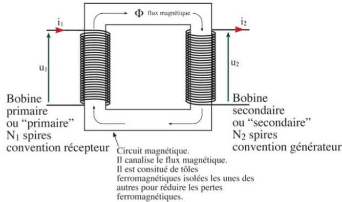
Le courant  $i_1$  est dû à un circuit connecté à la bobine du "primaire" : on peut modéliser avec un générateur de Thévenin, c'est-à-dire une fem  $e_1$  et une résistance  $R_1$ .
