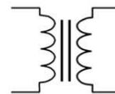
On a un système électrique : le transformateur est un convertisseur **statique** (pas de pièce en mouvement). Il transforme une tension sinusoïdale en une autre tension sinusoïdale de valeur efficace différente.
