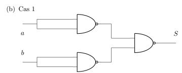
Quelle est l'expression booléenne de la sortie S en fonction de a et b? Vous utiliserez l'algèbre booléenne qui donne  $S=\overline{a\cdot b}=\overline{a}+\overline{b}$  pour une porte NAND qui peut se lire : "NON( A ET B ) est équivalent à : NON( A ) OU NON( B ) "
