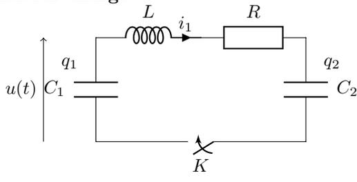
Le condensateur  $C_1$  porte initialement la charge  $Q_1$ , le condensateur  $C_2$  étant déchargé. On ferme l'interrupteur à  $t = 0$ . On suppose que  $C_1 = C_2 = C$ .
