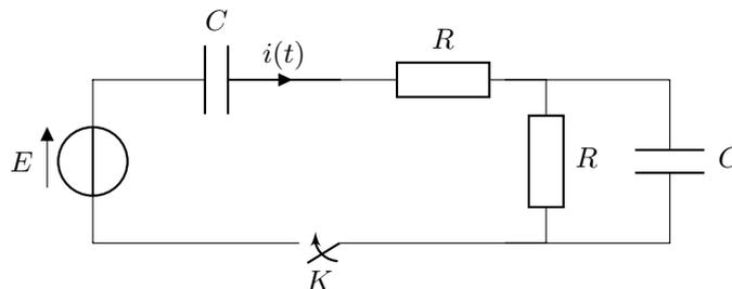
On suppose que les condensateurs ne sont pas chargés à la date  $t = 0$ . On ferme l'interrupteur à  $t = 0$ . On posera  $\tau = RC$ .
