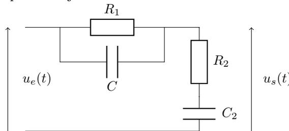
Le filtre ci-dessus est un dérivé du "classique" filtre de Wien. On pose  $\tau_1 = R_1 C_1$  et  $\tau_2 = R_2 C_2$ .
